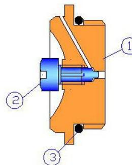
В латунном корпусе воздухоотводчика (1) имеется калиброванное воздуховыпускное отверстие диаметром 2 мм, которое в обычном состоянии перекрыто латунным винтом (2). При вывинчивании винта (2) скопившиеся в радиаторе газы через проточки винта и корпуса через газоотводный канал корпуса выходят наружу. Монтажное уплотнение обеспечивается с помощью кольца из EPDM (3)
